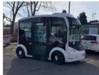
La CTS a testé la navette Cristal sur la ligne 15a. Fabriquée par Lohr Industrie 100 % électrique qui se veut collaboratif et numérique. Spécialisée pour les milieux urbains, composée de 2 à 4 véhicules. La navette est conduite par un chauffeur. De plus, le véhicule est accessible aux personnes à mobilité réduite.
