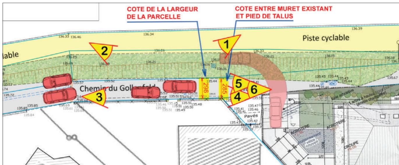
*Relevé du géomètre expert avec superposition des flux de voitures. En gris le chemin du Gollenfeld, en vert le talus (dénivelé de 90 cm) dans lequel est enterré le tuyau de collecte des eaux usées (diamètre environ 1 mètre 50) et en jaune la piste cyclable*
